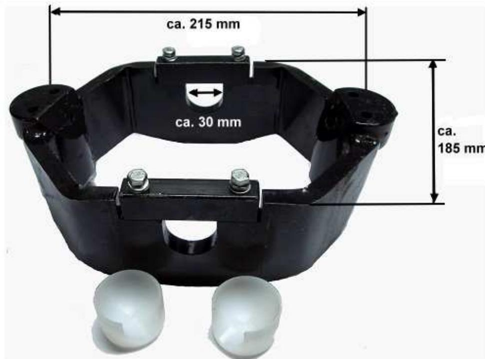
Der o. g. Kardanring ist für Teleskopzylinder der UNIMOG® Fahrzeuge vom Typ UNIMOG® 404, UNIMOG® 406, UNIMOG® 411, UNIMOG® 421 sowie diverse weitere Typen geeignet! Je nach dem, welcher Aufbau auf dem Fahrzeug verwendet wird, ist dieser Teleskopzylinder bei folgenden UNIMOG® Typen ebenfalls passend: UNIMOG® Typ U403, U404, U406, U407, U411, U417, U421, U90, U1000, U1200, U1400, U1450, U1600, U1650, U1700, U1750, U2100, U2150 ...
